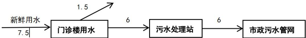
图3 项目用排水水量平衡图
