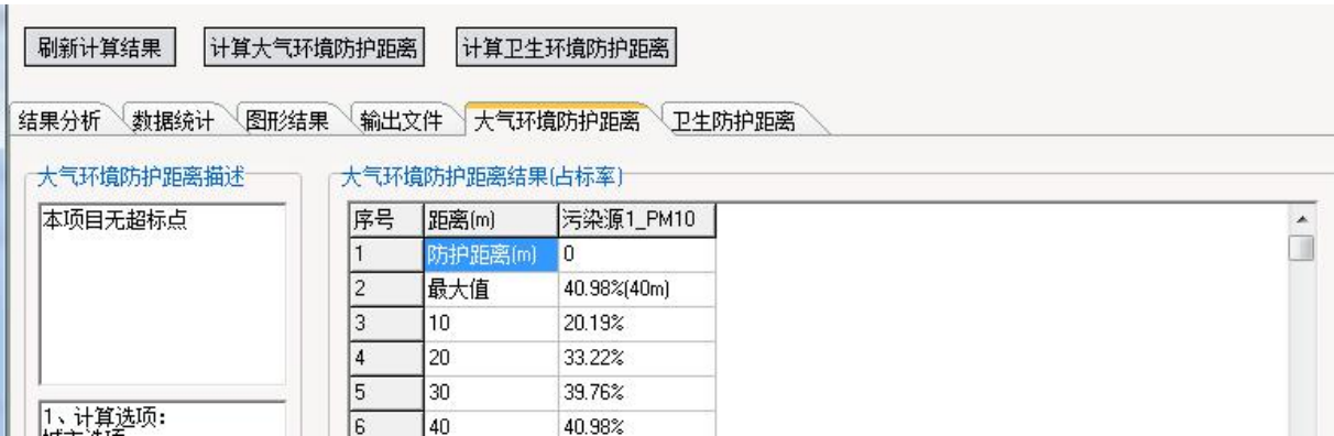
图 7 项目粉尘无组织排放大气防护距离计算截图
